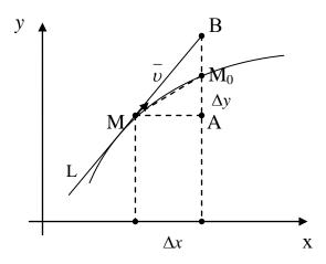
Если точка M движется с постоянной скоростью, то она пройдёт путь по прямой  $MM_0$  равной  $\Delta y$  .Средняя скорость за время  $\Delta x$   $\upsilon_{cp} = \frac{\Delta y}{\Delta x}$ , мгновенная скорость движения точки  $\upsilon = \lim_{\Delta x \to 0} \frac{\Delta y}{\Delta x} \to \upsilon = f'(x)$ .
